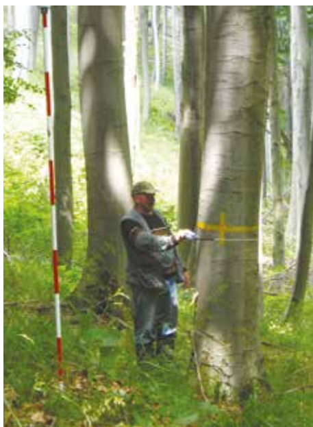
9. kép: Mellmagassági átmérő mérése
