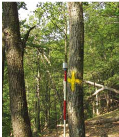
3. kép: Állandósított mintapont a pontközepet jelző rúddal és festett fával
